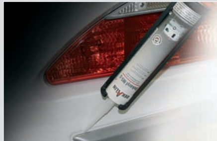
Verkleben von Kantenprofilen
